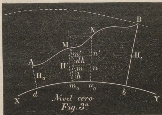
Conociendo  $H_0$  y las diferencias parciales de nivel, sucesivamente dadas por las superficies intermediarias de nivelación, comprendidas entre A y B, se deducen por el procedimiento ordinario las altitudes usuales de todos los puntos intermedios y finalmente la del punto B. Es suficiente añadir, como demostraremos ahora—aunque nos salgamos un poco del asunto principal—para transformar estas altitudes usuales en altitudes ortométricas, una corrección expresada por la fórmula
