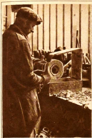
Trabajo del cilindro de marfil con el torno.
