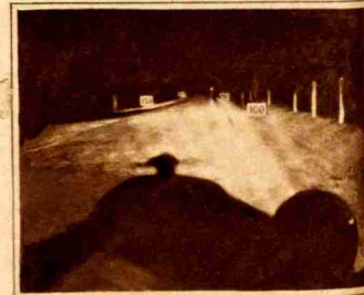
Este grabado muestra el notable largo alcance obtenido con la faro «Ilico-Ryan-Lite». Obsérvese que con el alcance de 200 pies (60 m.) el alumbrado de la carretera es excelente, y más se en cuenta que no hay deslumbramiento. El faro «Ilico-Ryan-Lite» usado al hacer esta fotografía, está provisto de lámparas Standard de 21 bujías.
