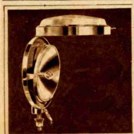
Esta vista del faro «Ilico-Ryan-Lite», con la tapa levantada, muestra la forma diámetrica del reflector y la disposición de la lámpara, que no es necesario enfocar. Toda la luz producida por la lámpara se utiliza completamente por el científico diseño del reflector y de la lente del faro «Ilico-Ryan-Lite».
