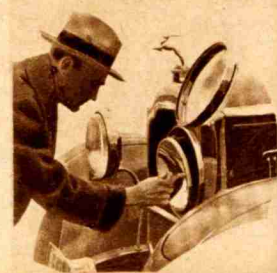
La tapa del faro, montada con charnola, permite cambiar
